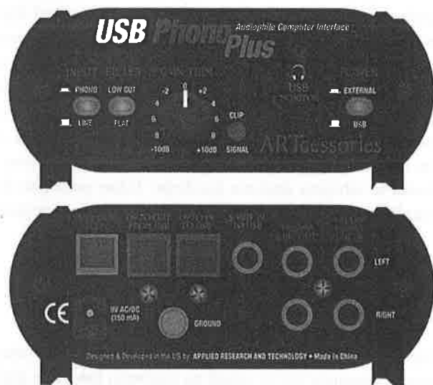
Slika 10: Pretpojačalo zvučnog signala (prednja i stražnja strana) (Izvor: Harmony Central, http://news.harmony-central.com/ )
